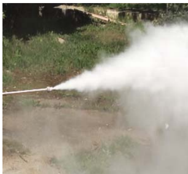
Рис. 4. Демонстрация свободной подачи порошковой струи при калибровке расходной характеристики распылителя
