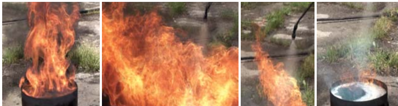
Рис. 10. Фрагменты процесса тушения бензина пленкообразующими водными растворами
