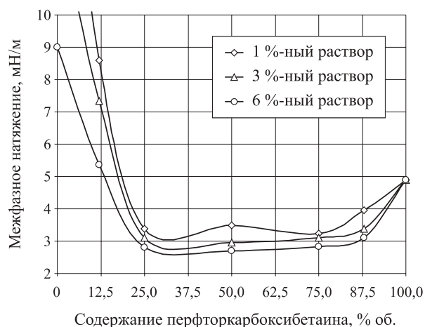
Рис. 3. Межфазное поверхностное натяжение водного раствора концентраций 1, 3 и 6 % на границе с гептаном в системе децилсульфат натрия – перфторкарбоксибетанин
