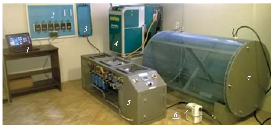
Рис. 1. Внешний вид экспериментальной установки: 1 — ПК со специальным программным обеспечением “ZetLab”; 2 — контрольно-измерительный комплекс; 3 — ротаметр; 4 — винтовой компрессор; 5 — мембранный воздухоразделительный модуль; 6 — прибор измерения объема инертного газа; 7 — экспериментальный резервуар (0,9 м 3 ) с размещенными в нем датчиками концентрации кислорода
