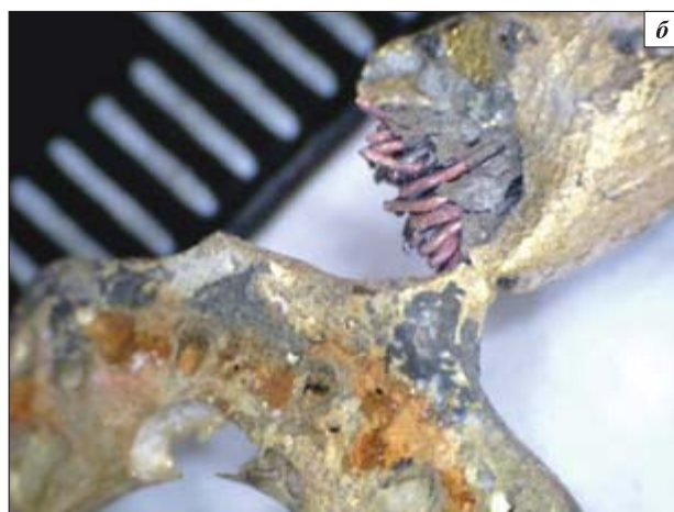
Рис. 2. Повреждения кабельного наконечника провода массы автомобиля Lada 21144: a — общий вид; б — увеличение
