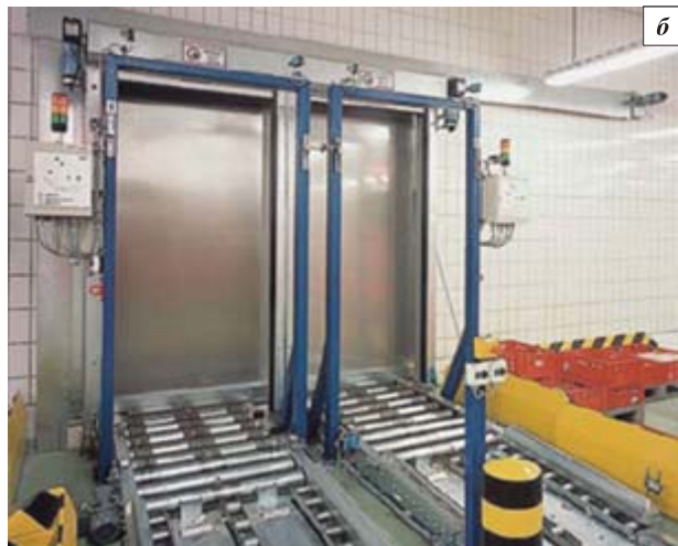
Рис. 9. Преграды для проходящих роликовых конвейеров в открытом (а) и закрытом (б) состоянии
