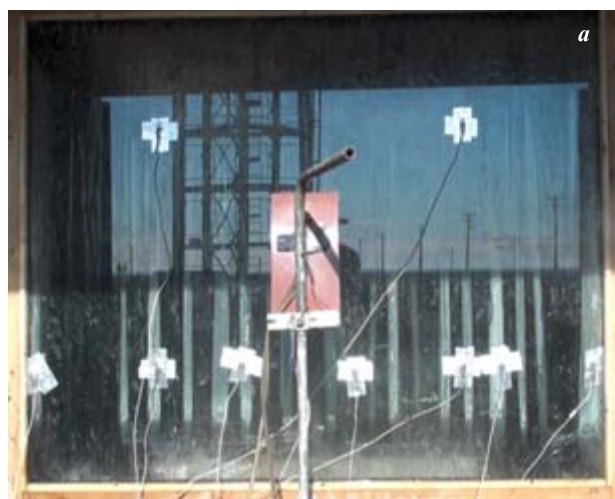
Рис. 5. Образец триплекса 5-1-5 после испытания с орошением обогреваемой стороны (начало испытания) (а) и необогреваемой стороны (б)
