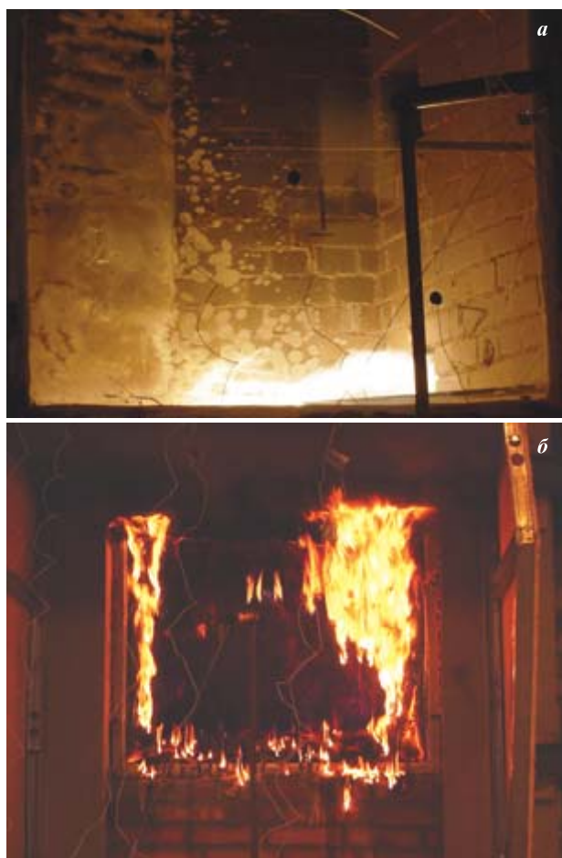
Рис. 1. Образец листового стекла (4 мм) с полимерной пленкой, наклеенной с обогреваемой стороны, в начале испытания (а) и после выключения форсунок (б)
