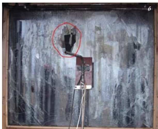
Рис. 5. Образец триплекса 5-1-5 после испытания с орошением обогреваемой стороны (начало испытания) (а) и необогреваемой стороны (б)
