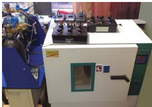
Рис. 4. Испытательный стенд с камерой тепла-холода типа КТХ-74
