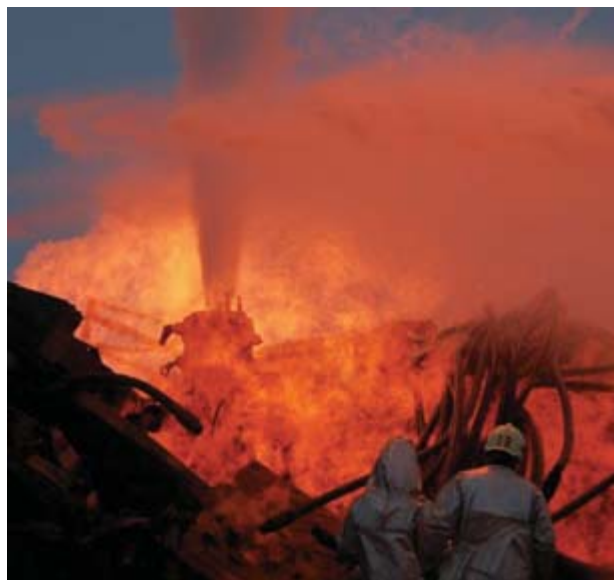
Рис. 2. Создание компактной струи газа на устье скважины
