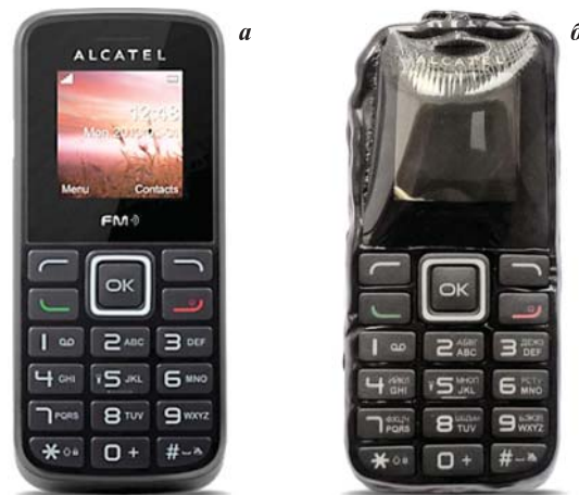
Рис. 6. Состояние телефонов № 1 и 2 (а) и № 3 (б) после воздействия на них высоких температур
