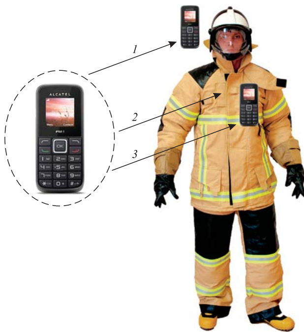
Рис. 5. Расположение мобильных телефонов на боевой одежде пожарного: 1 — каска; 2 — внутренний карман; 3 — внешний карман
