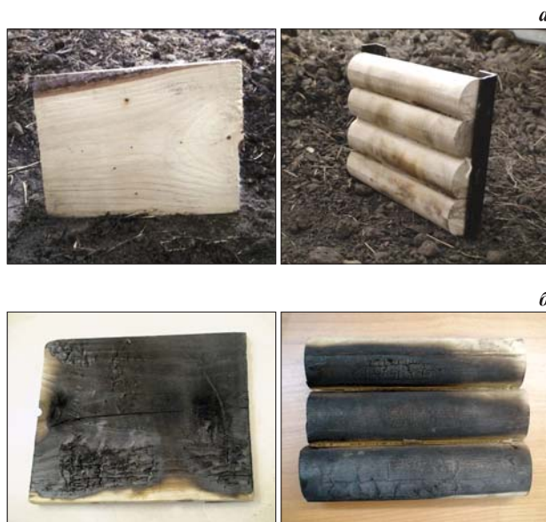
Рис. 5. Вид испытуемых модельных образцов древесины до испытаний (а) и после воздействия на них фронта модельного низового лесного пожара (б)
