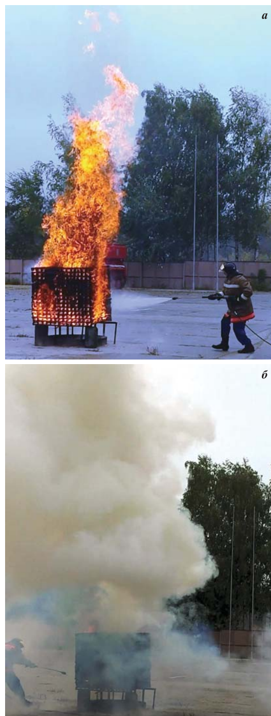
Рис. 1. Модельный очаг пожара ранга 15А (штабель из 450 брусков 1190×40×40 мм): а — в начале тушения; б — через 23 с после начала тушения
