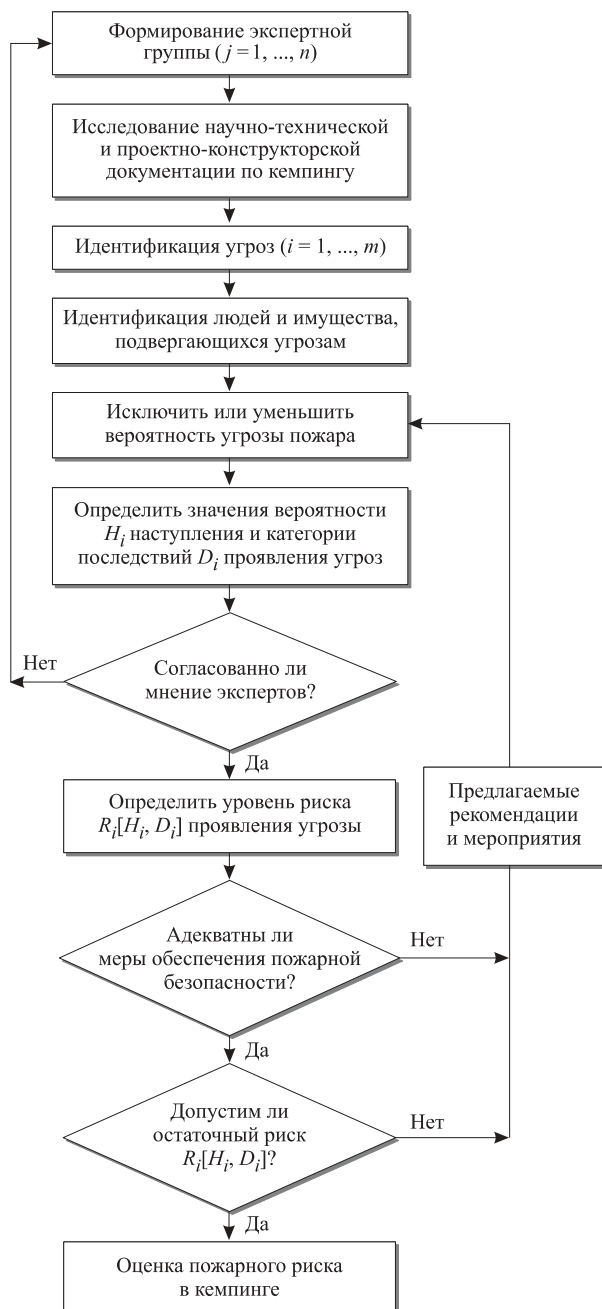
Рис. 1. Блок-схема выполнения процедур по оценке пожарного риска в кемпинге и его снижению
