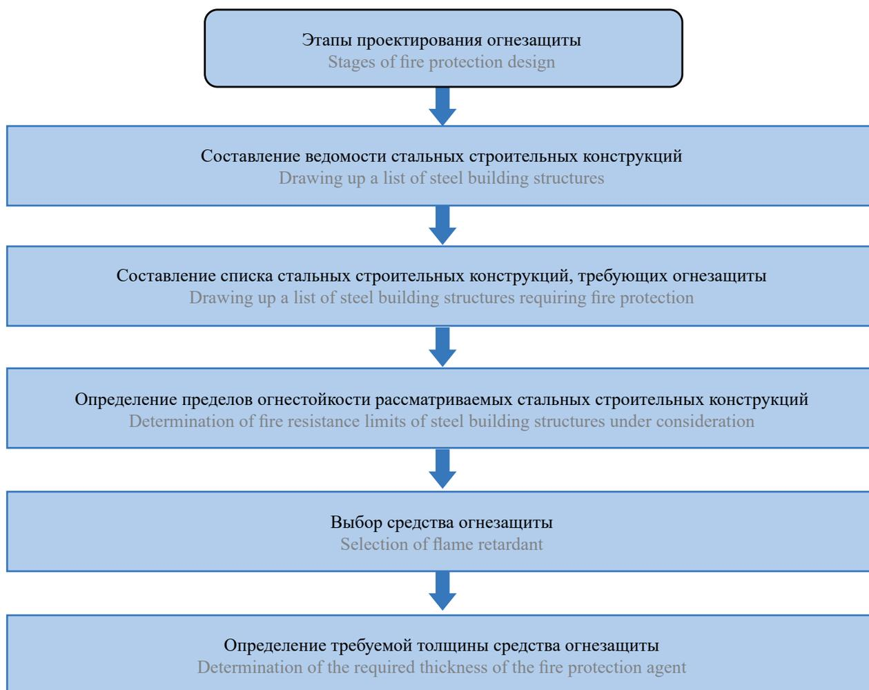
**Рис. 3.** Алгоритм проектирования огнезащиты строительных конструкций
