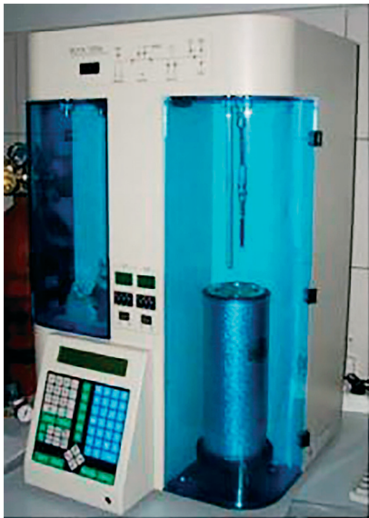
Рис. 2. Анализатор размера пор и площади поверхности NOVA 1200 (QUANTACHROME) Fig. 2. NOVA 1200 pore size and surface area analyzer (QUANTACHROME)
