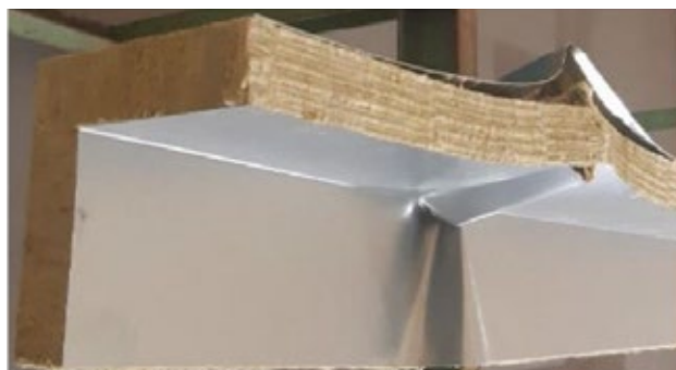
Рис. 3. Угловой прогиб из сэндвич-панели под нагрузкой [8] Fig. 3. Angular deflection of a sandwich panel under load [8]
