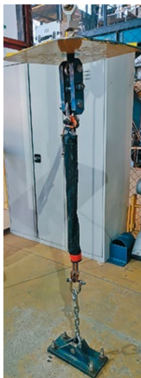
Рис. 7. Положение полиспаста при испытании статической прочности Fig. 7. Position of the block pulley during the static strength test
