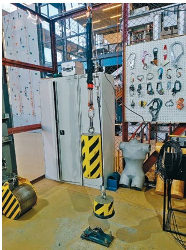
Рис. 5. Испытания полиспафта Fig. 5. Testing of the block pulley
