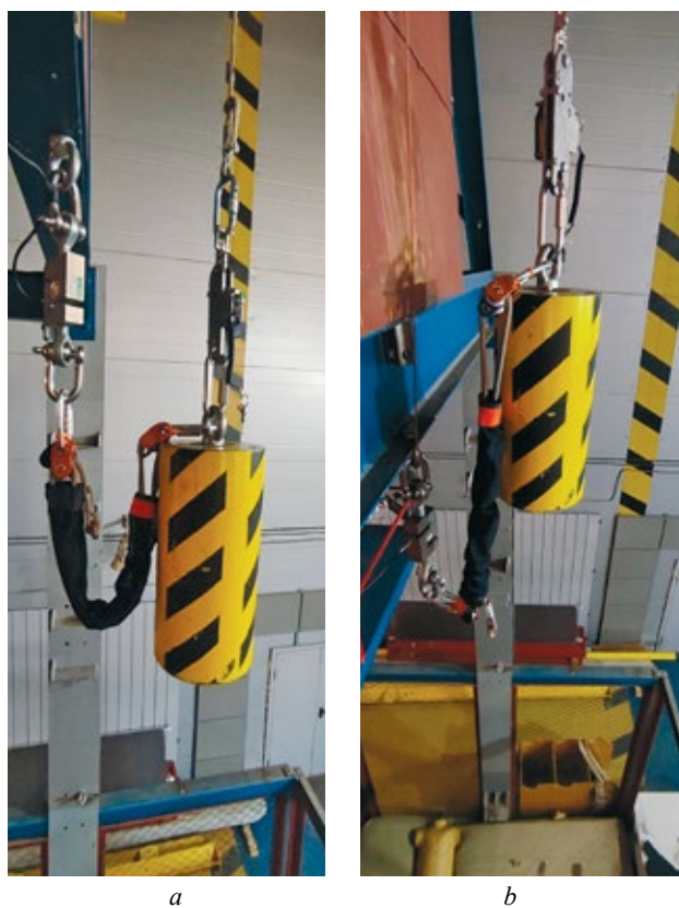
Рис. 13. Падение с факторами 1 (а) и 2 (b) Fig. 13. Fall factors 1 (a) and 2 (b)
