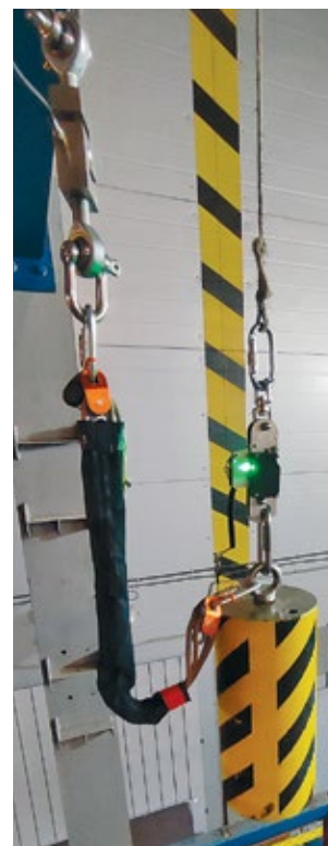
Рис. 8. Положение полиспаста при испытании динамической рабочей характеристики Fig. 8. Position of the block pulley when testing the dynamic operating characteristic
