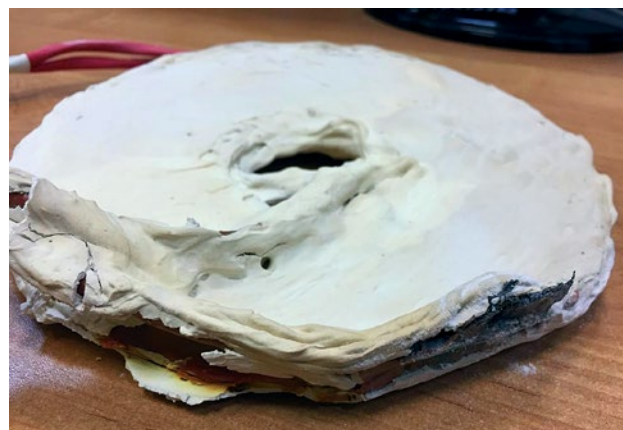
Рис. 4. Внешний вид образца кабельной линии типа КМВЭВ 1 \times 2 \times 1,5 при нагреве до 300\text{ }^{\circ}\text{C}
