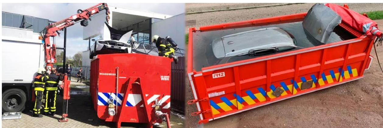
Рис. 5. Погружение электромобиля в контейнер с водой
