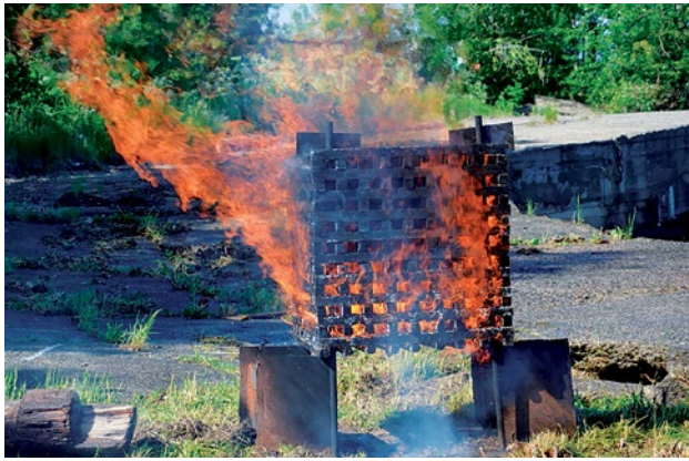
Рис. 2. Огневые испытания на модельном очаге по программе и методике испытаний АБМИ.112.00.000 ПМ Fig. 2. Fire tests on a model hearth according to the program and test methodology ABMI.112.00.000 PM
