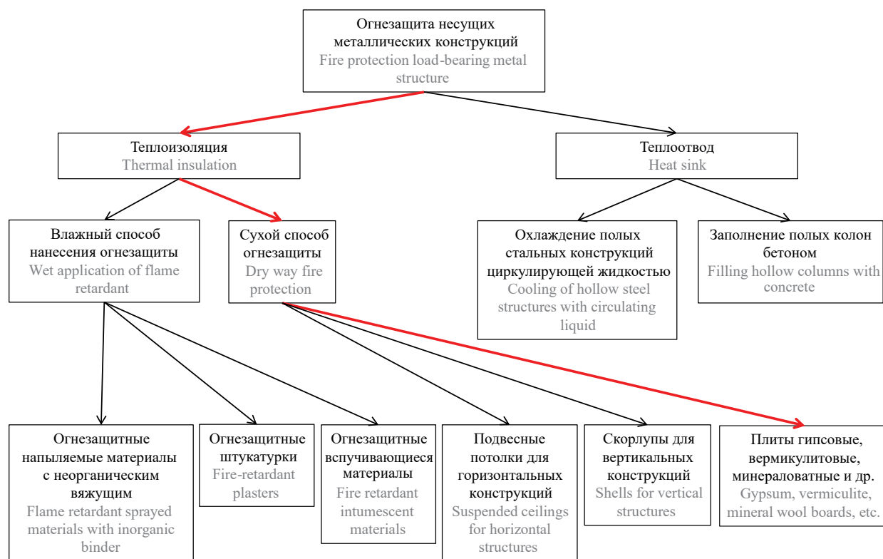
Рис. 1. Структурно-методологическая схема выбора огнезащиты для стальных конструкций [10]
