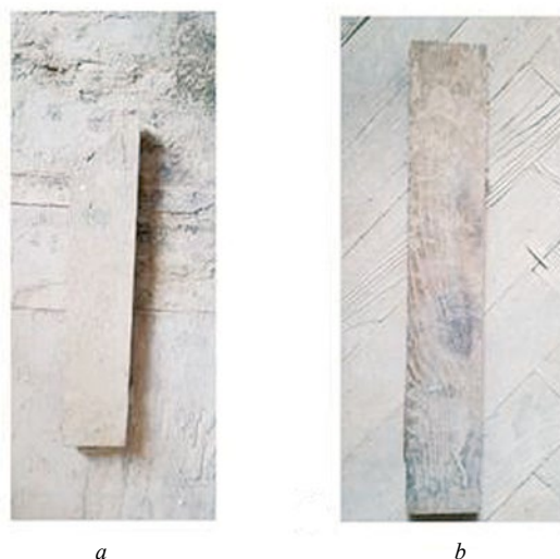
Рис. 2. Образцы для исследования: а — древесина дуба (образец № 1); б — древесина ясеня (образец № 2) Fig. 2. Specimens for research: a — oak wood (specimen No. 1); b — ash wood (specimen No. 2)
