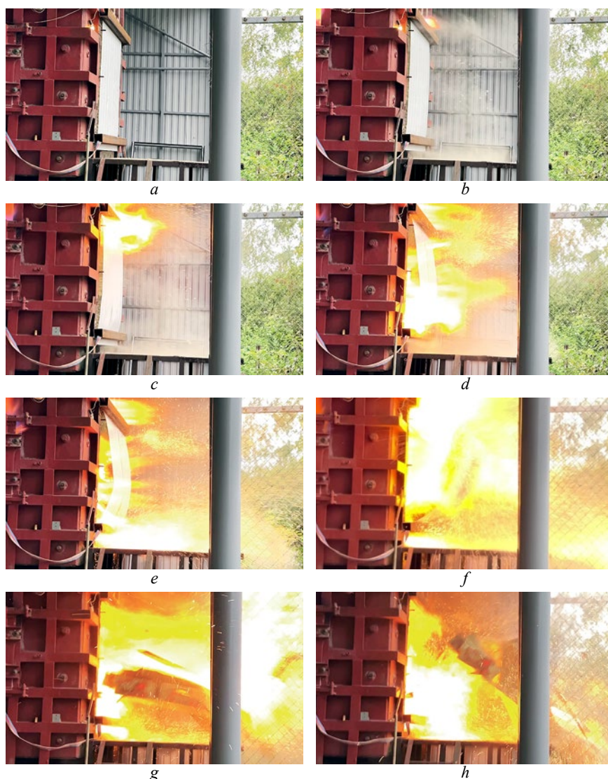
Рис. 3. Процесс взрыва пропановоздушной смеси в камере (эксперимента 2) в разные моменты времени: a — кадр 432,0 мс, соответствует точке 1 на рис. 4; b — кадр 515, 532,0 мс, соответствует точке 2 на рис. 4; c — кадр 525, 596,1 мс, соответствует точке 3 на рис. 4; d — кадр 535, 660,2 мс, соответствует точке 4 на рис. 4; e — кадр 545, 724,3 мс; f — кадр 555, 788,4 мс; g — кадр 565, 852,5 мс, соответствует точке 5 на рис. 4; h — кадр 575, 916,6 мс
