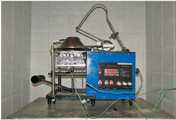
Рис. 2. Радиационная панель Fig. 2. Radiant panel
