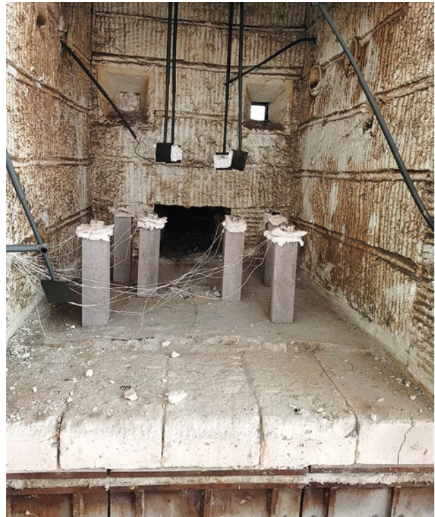
Рис. 2. Общий вид малогабаритной печи с установленными образцами перед испытанием
