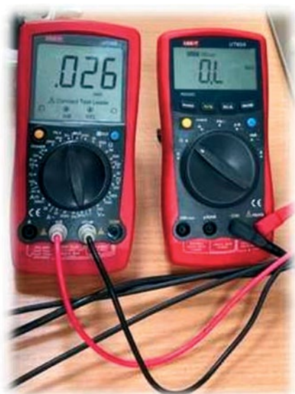
Рис. 7. Измерение параметров индуктивности и сопротивления испытуемого образца с помощью тестера
