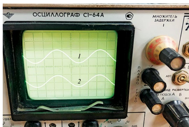
Рис. 4. Визуальный контроль формы сигнала на экране осциллографа: 1 — образцовый сигнал; 2 — сигнал с выхода испытуемого образца
