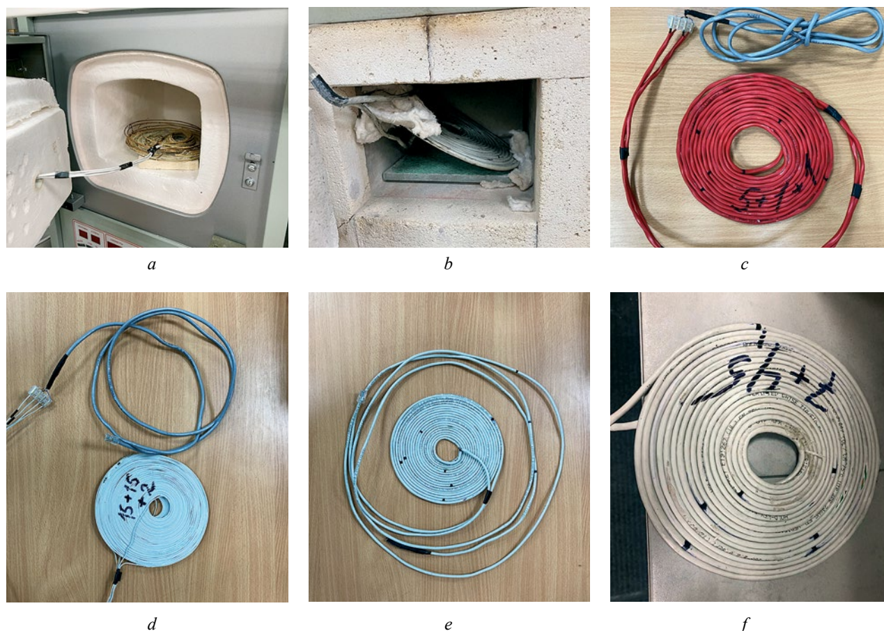
Рис. 8. Образцы кабелей и проводов и их размещение в муфельной печи: a — образец двухжильного нагревательного провода типа ПНСВ 1×1,2 после воздействия температуры в муфельной печи; b — образец кабеля типа витая пара в муфельной печи; c — образец провода типа КМВЭВ 1×2×1,5; d — образец двухжильного нагревательного провода типа ПНСВ 1×1,2; e и f — образцы кабеля типа витая пара
