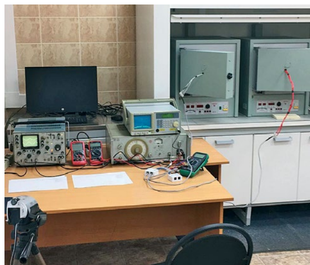
Рис. 3. Общий вид стенда для проведения испытаний проводов и кабелей
