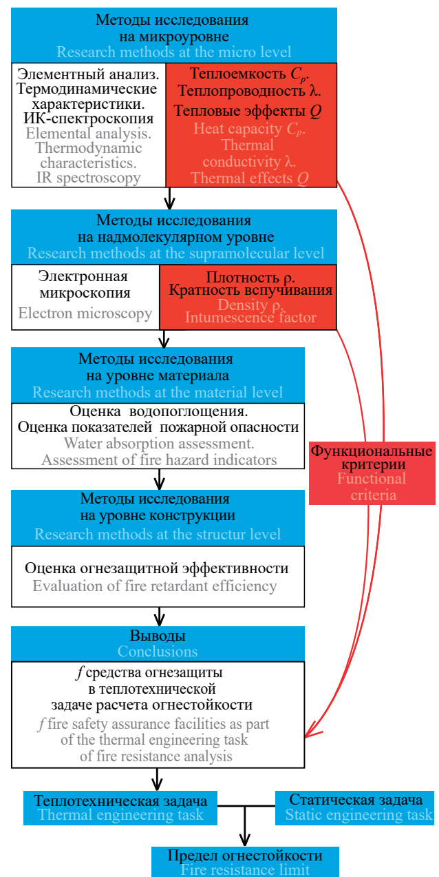
Рис. 3. Блок-схема для исследования параметров средств огнезащиты для металлических конструкций и материалов Fig. 3. The block diagram for the study of fire safety parameters for metal structures and materials
