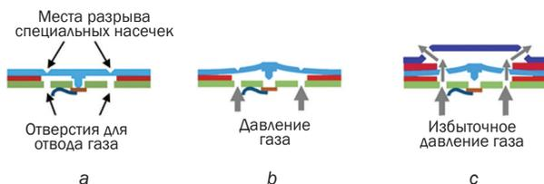
Рис. 3. Принцип действия устройства прерывания тока «CID»: а – нормальный режим работы; б – отключение питания положительной клеммы аккумулятора; с – выброс газообразного электролита через вентиляционные отверстия с разрывом насечек предохранительного клапана
