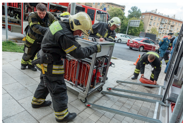
Рис. 3. Транспортировка и развертывание мотопомп
