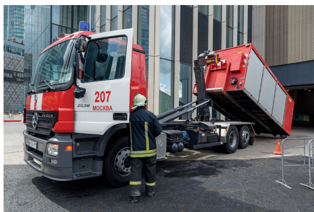
Рис. 2. Пожарный контейнер с пожарным оборудованием
