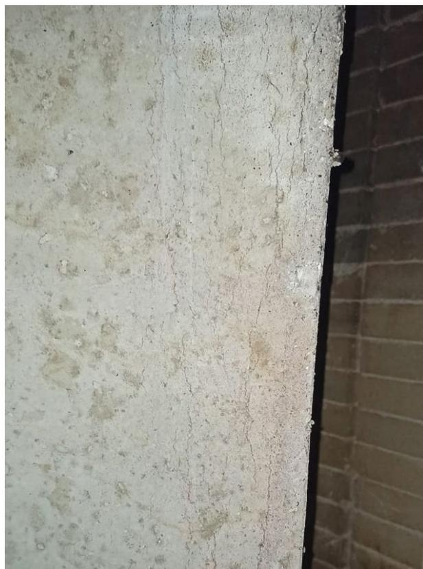
**Рис. 2.** Внешний вид опытного образца (с ППМФ в бетоне) после третьего огневого эксперимента
