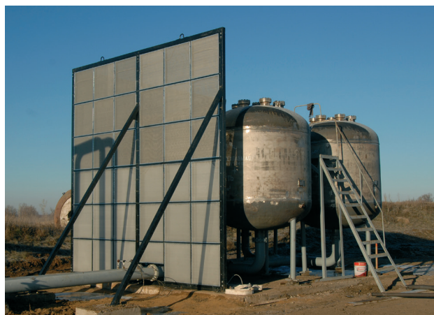
Рис. 2. Общий вид секции водопеночного теплозащитного экрана
