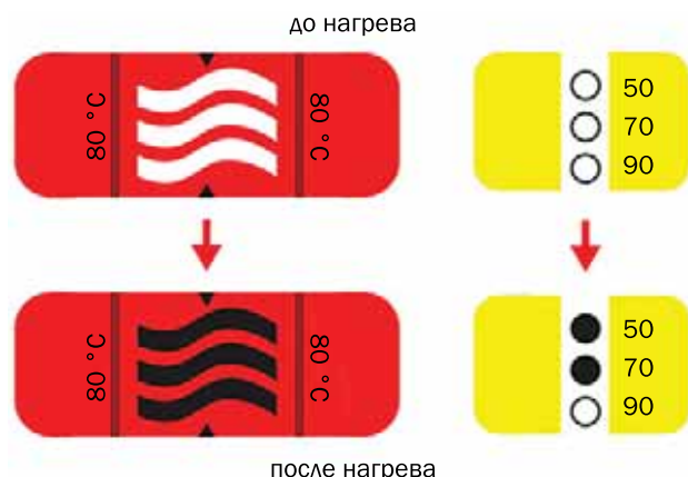
Рис. 1. Общий принцип действия индикаторных наклеек и стикеров
