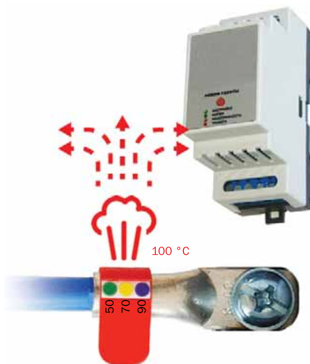
Рис. 2. Общий принцип действия газоаналитической системы непрерывного мониторинга контактных соединений
