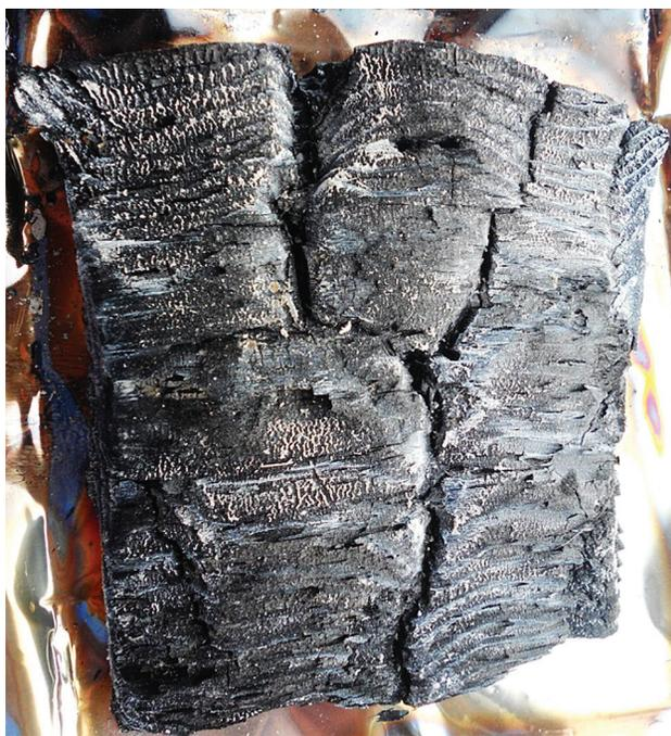
Рис. 4. Вид образца древесины сосны после беспламенного горения
