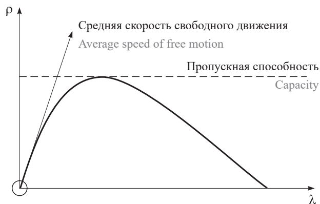
Рис. 8. Основная диаграмма транспортных потоков [19]: \rho — интенсивность потока (число автомобилей в единицу времени); \lambda — плотность потока (число автомобилей на единицу длины)
