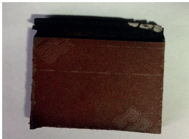
Рис. 1. Образец ламината, полученный в результате обжига при температуре 200 °С в течение 600 с
