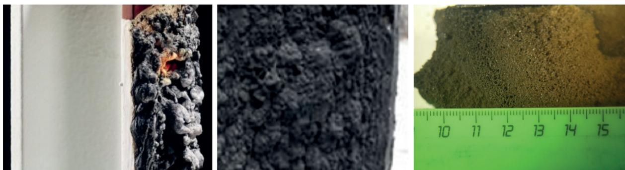
**Рис. 1.** Вспучивание огнезащитного покрытия при нагревании (слева), наружная поверхность вспученного кокса (в центре), пористая структура вспученного кокса (справа)
